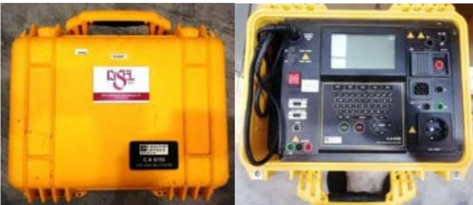
MEDIDOR MULTIFUNCIÓN CHAUVIN ARNAUX MODELO CA6155 DE RYSEL Y LAS MEDICIONES RELACIONADAS CON LA TIERRA QUE OFRECE:
